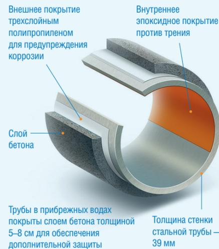
Внешнее покрытие трехслойным полипропиленом для предупреждения коррозии
